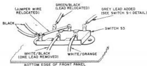
OPERATION SWITCH WIRING
